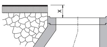
**x** = stavební výška rámu + přídavek (5 až 35 mm)
