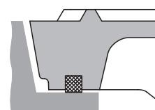
Všechna víka a mříže jsou v rámci zajištěna vlastní hmotností (dle bodu 7.8 ČSN EN 124). V ČSN však přesná hodnota není uvedena, proto byla použita z rakouské normy ÖNORM B 5110, kde je hodnota 275 kg/m<sup>2</sup>. Ta platí pro poklopy a vtokové mříže D400, E600 a F900.
