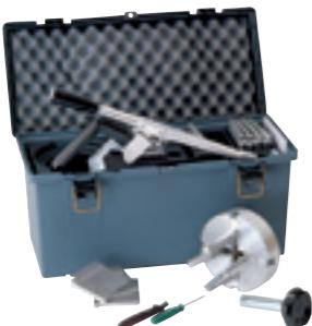
RASCHIATORE MECCANICO PER TUBI CON d<sub>e</sub> 75÷315
