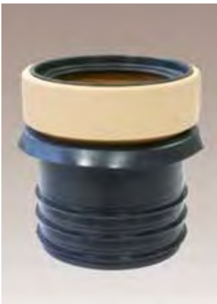
Napojovací kameninový element C DN 200 (připravuje se pro náhradu kameninového napojení DN 200 v kombinaci s B kroužkem)
